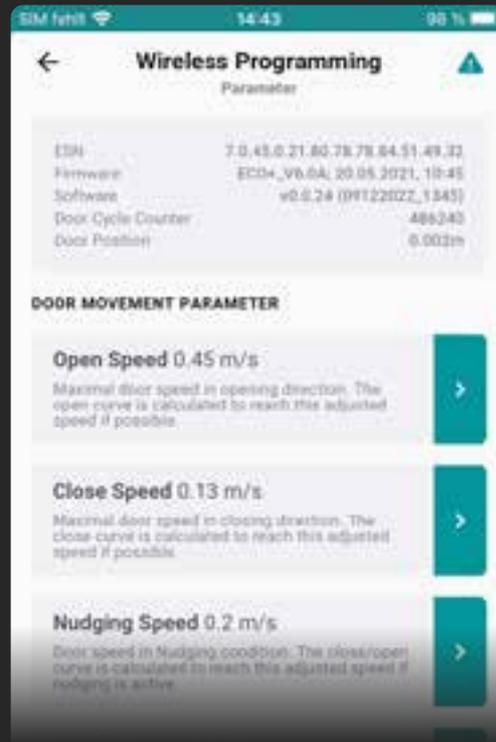
Remplace intégralement l'outil de programmation obsolète, facilite le réglage des paramètres de la porte et le rend **plus intuitif**, grâce à:
